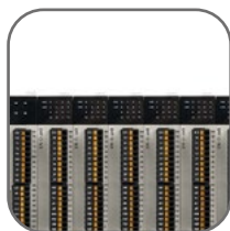
Расширение до 256 точек ввода/вывода
