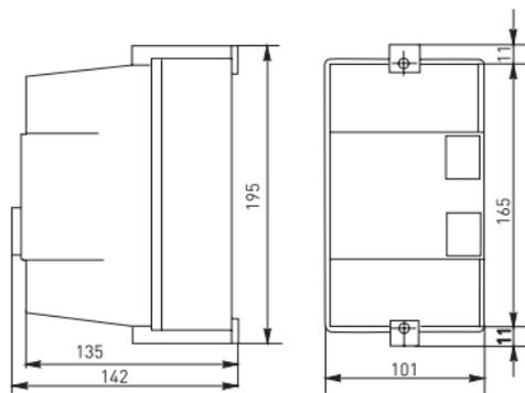
Рис. 8 Габаритные размеры КМЭ 2510, КМЭ 3210
