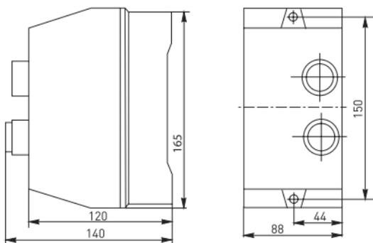
Рис. 7 Габаритные размеры КМЗ 0910, КМЗ 1210, КМЗ 1810
