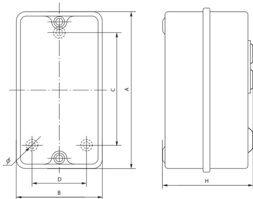
Рис. 10 Габаритные размеры реверсивного пускателя КМЭ
