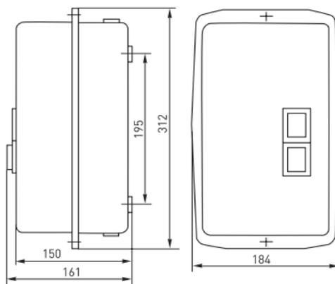
Рис. 9 Габаритные размеры КМЭ 4011, КМЭ 5011, КМЭ 6511, КМЭ 9511
