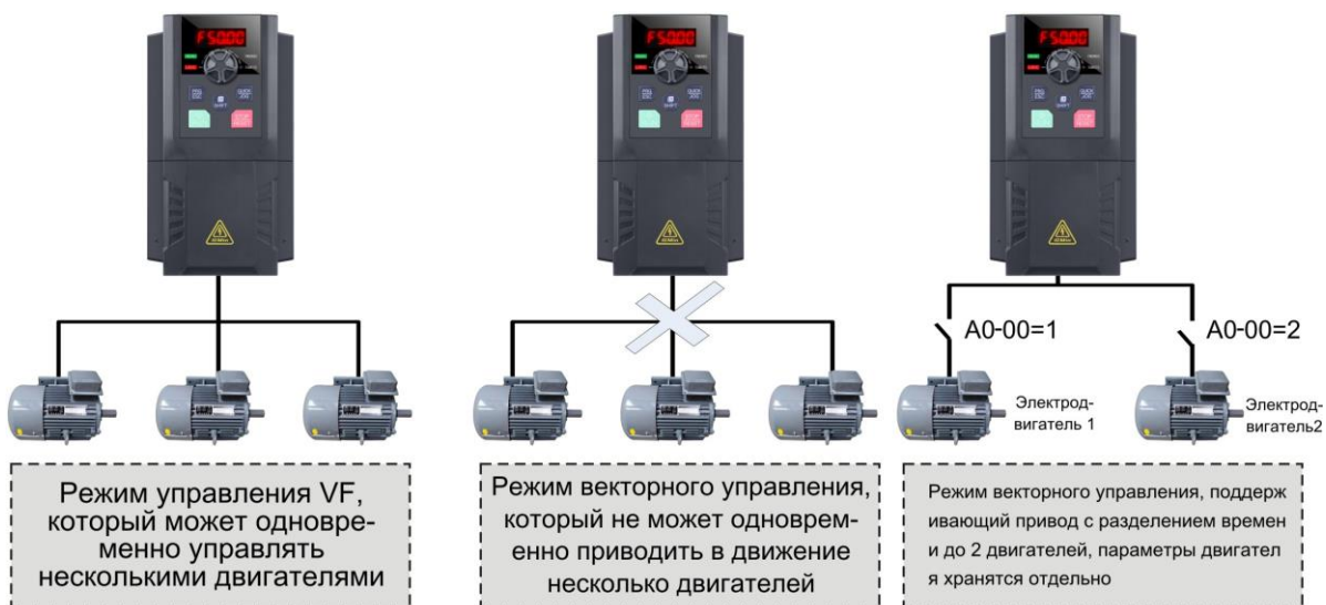
Рисунок 4 - 26 Переключение многоблочных двигателей
