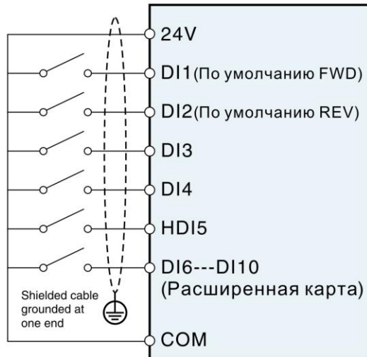
Рисунок 3-14 Диаграмма подключения к четырем различным режимам цифрового ввода
