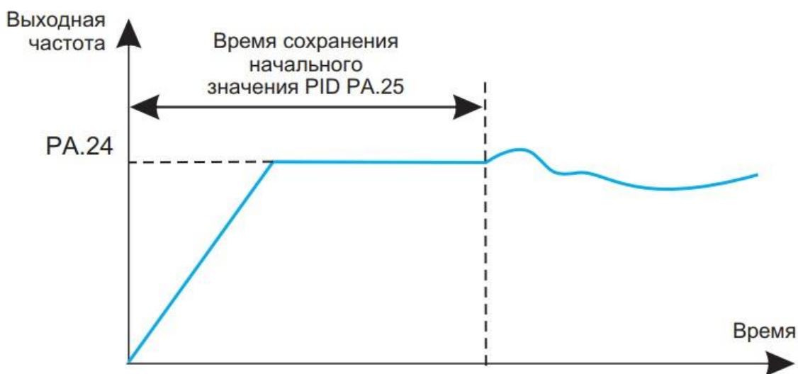
Рисунок 6 - 25 Функциональная схема начального значения PID
