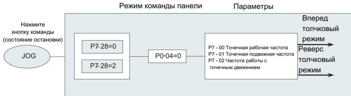
Рисунок 4 - 15 Схема настройки параметров толчкового режима
